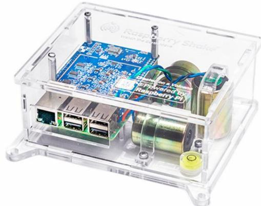
**Figure 9** Un sismomètre Raspberry Shake bon marché de type RS3D, qui a notamment été installé dans plus de 40 écoles suisses dans le cadre du programme seismo@school. © Raspberryshake.org
