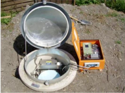
**Figure 6** Une des plus de 200 stations sismiques que le SED a installé en Suisse.
