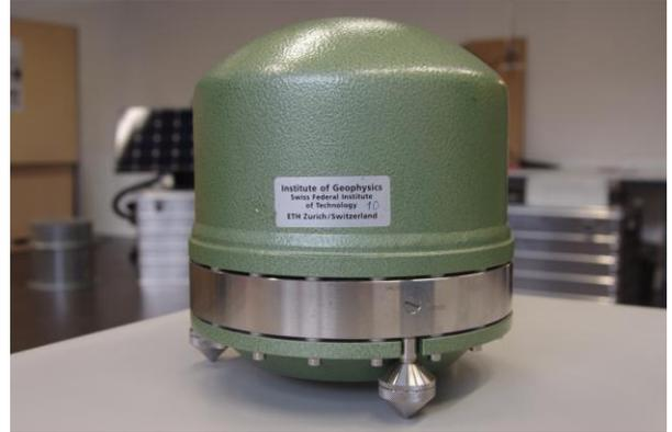
**Figure 7** Un sismomètre à large bande très sensible, capable d'enregistrer les plus faibles vibrations du sol (vitesses). Les sismomètres à large bande sont particulièrement bien adaptés à l'enregistrement de séismes locaux de faible intensité, de séismes régionaux d'intensité moyenne et de séismes mondiaux d'intensité moyenne à forte.
