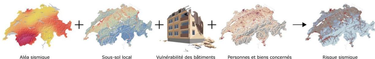
Figure 20 Composants pour le calcul du risque sismique.
