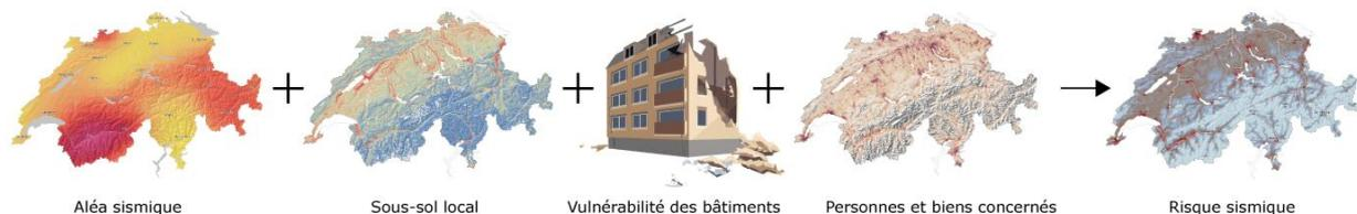
**Figure 3** : Les quatre facteurs de détermination du risque sismique. Remarque : il existe également d'autres définitions pour les différents termes (p. ex. « exposition » pour les personnes et les biens concernés).
