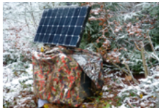
Stazione temporanea di registrazione sismica ad energia solare nell'ambito del progetto geotermico a San Gallo
